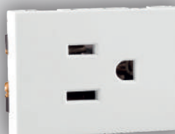
CONTACTO SENCILLO POLARIZADO ATERRIZADO 36 mm Código 1351 127 V ~ 60 Hz 15 A EMPAQUE: 10/400
